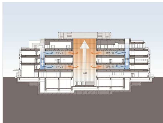
自然換気システム
