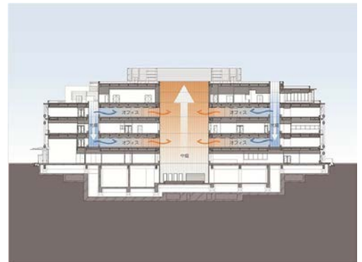
自然換気システム
