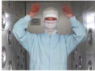
4. 空気のシャワーでほこりなどを吹き飛ばしてから、製造現場に入室します。
