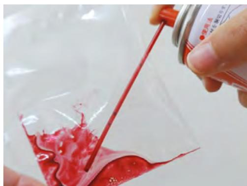
赤い浸透液を使って微細なシール不良がないかなど、「容器の密封性が保たれているか」を評価します。
