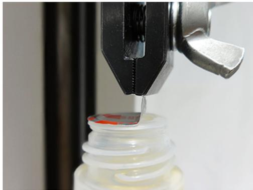
マヨネーズのアルミシールの開封しやすさを評価します。
