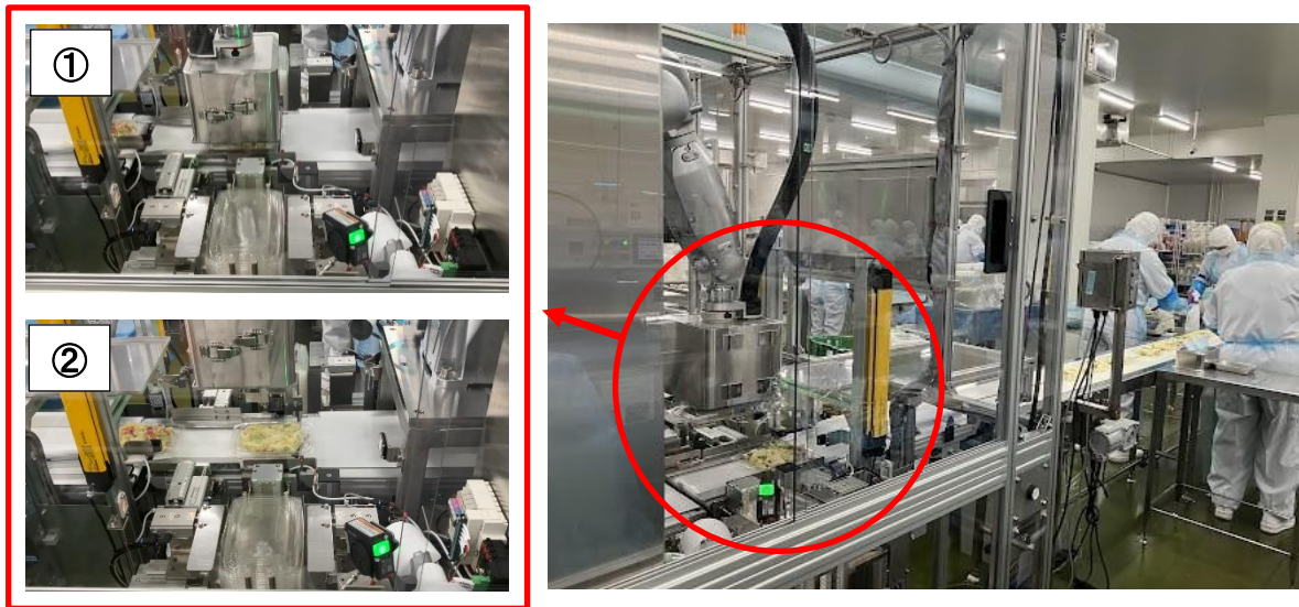
「惣菜用ふた閉めロボット」実運用の様子 写真①：手前に積み上げた容器のふたをロボットアームが取り、惣菜の容器に押し付ける 写真②：ロボットアームが上がり、ふた閉め完了
