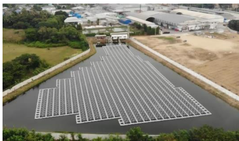
キューピータイランド工場敷地内の貯水池に設置された水上太陽光パネル
