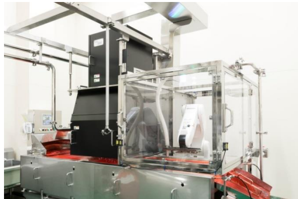
左の黒い装置が異物検査装置。検出された異物・夾雑物は、右の透明なBOX内のロボットアームに装着されたバキューム装置で吸い出して除去する。
