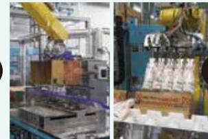
「箱の組み立て」「箱詰め」「出荷」の一連の作業を正確無比にロボットが実施。
