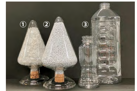
①油付きPETボトルを洗浄・粉砕したフレーク ②再生レジン ③再生ボトル
