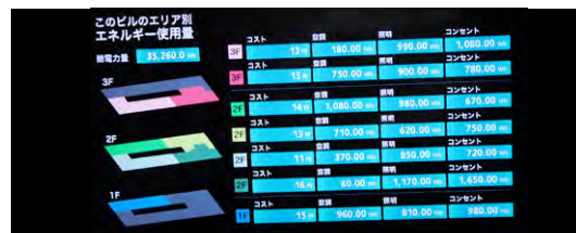
フロア電力消費量・金額を表示するサイネージ
