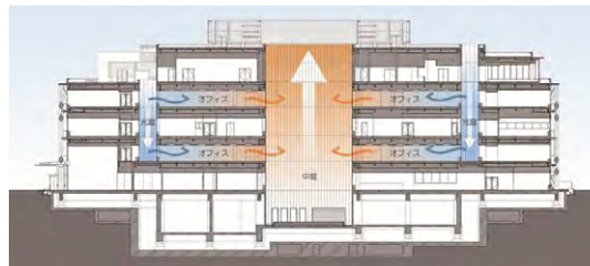
自然換気システム
