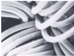
繊維に卵殻膜パウダーを付着させた新素材の拡大写真(電子顕微鏡写真600倍)
