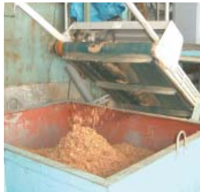
乾燥した汚泥( 挙母工場 )
